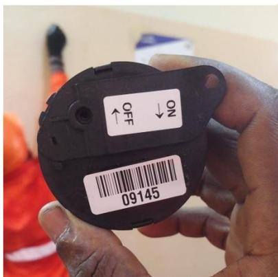
Rechercher du **Radon** dans un bâtiment signifie mesurer la concentration en radon de l'air (**en Bq/m<sup>3</sup>**) dans les pièces occupées du bâtiment. Pour cela on utilise des dosimètres.
